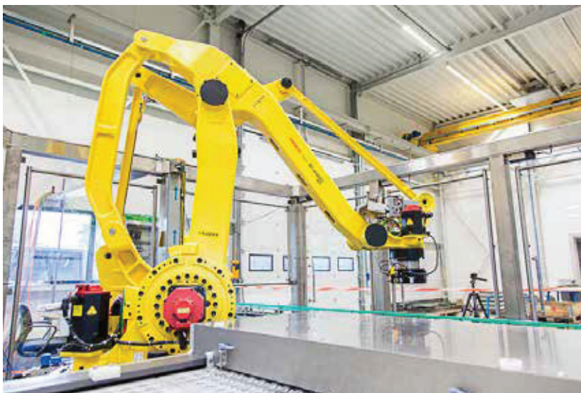
Sanders Machinebouw simuleert de functionaliteit van een nieuw te bouwen machine vaak eerst met een robotopstelling in het bedrijf.
